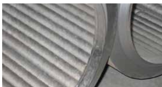
Pipes (Nickel alloy 825) Soudotape 825 + Record EST 236
