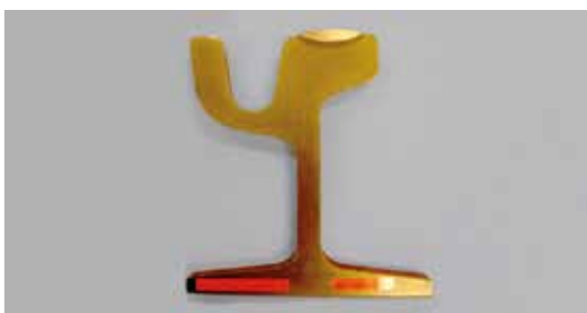
Rails (Alloy 317L) Soudotape 309L + Record EST 307
