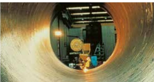
Separator Vessel (Nickel alloy 625) Soudotape 625 + Record EST 201
