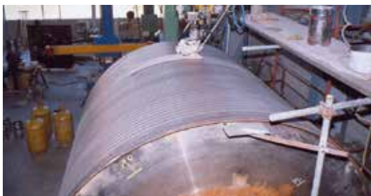
Paper Rolls (Alloy 14Cr2Ni1Mo) Soudotape 430 + Record EST 452
